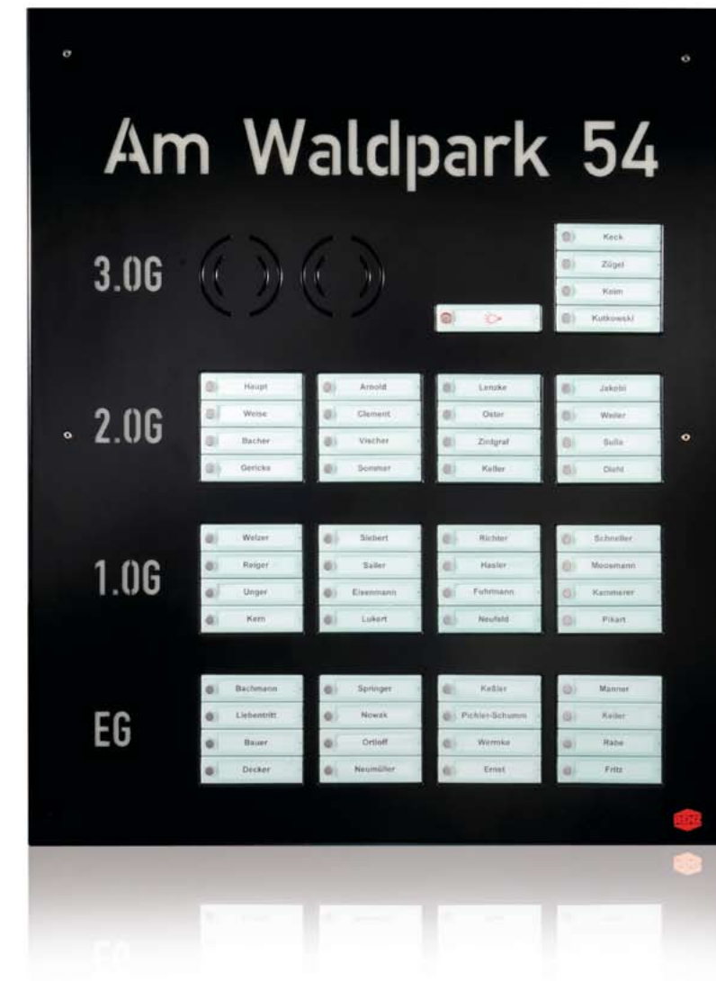
1 Unterputz-Klingelanlage Front aufklappbar 13 mm abgebogen, RSA2-kompakt in Blockbauweise, Durchgravur mit LED-Hinterleuchtung
